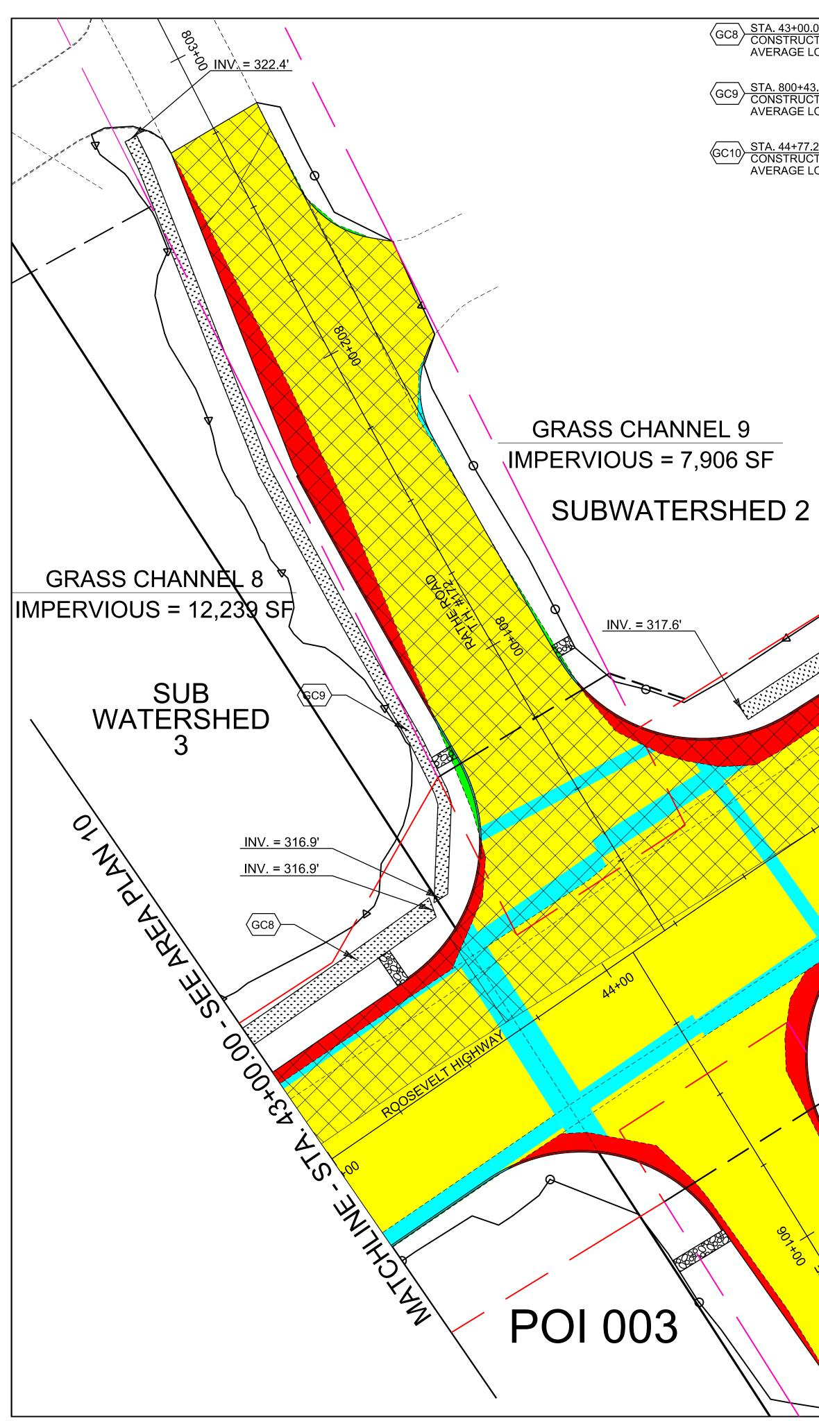
GC8 STA. 43+00.0, LT - STA. 43+67.4, LT CONSTRUCT 448' TOTAL GRASS CHANNEL AVERAGE LONGITUDINAL SLOPE = 1.3%
